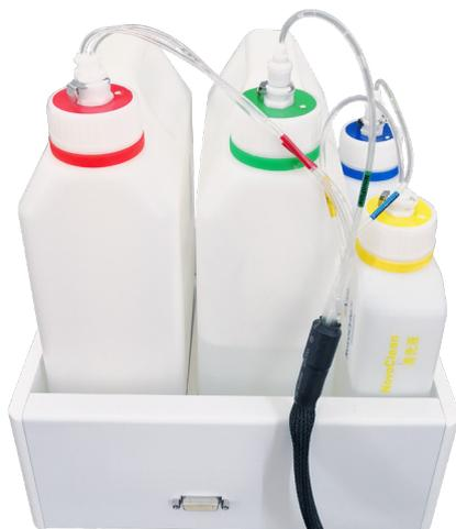
图1-7 储液瓶上的管路连接
