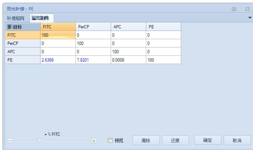
图3-23 通过编辑溢出矩阵调整 PE 信号溢出到其他通道的荧光补偿
